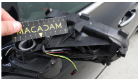
Afgebroken en/of verbogen spiegels
